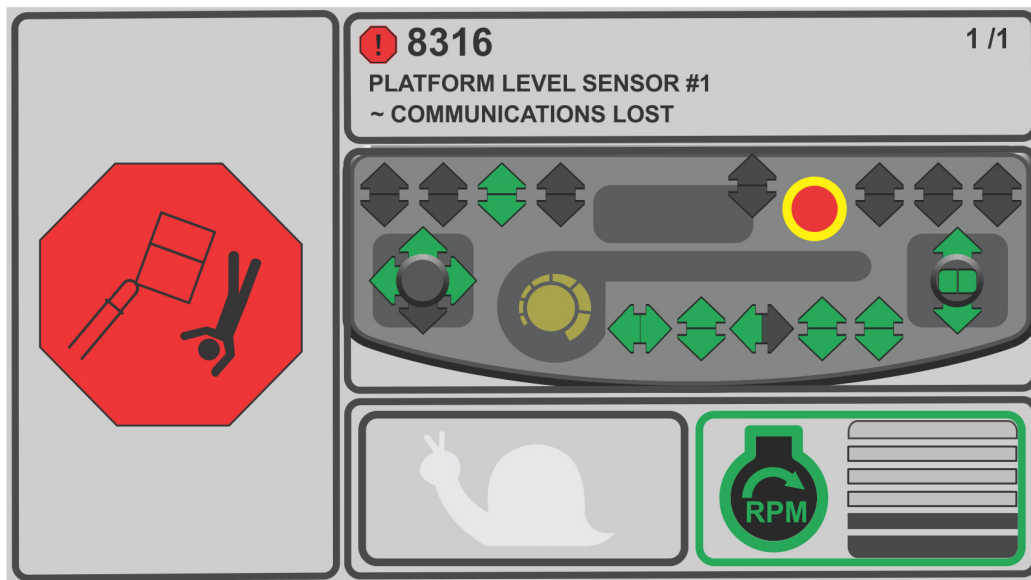
Figura 5-14. Ecranul DTC Sistem nivel
