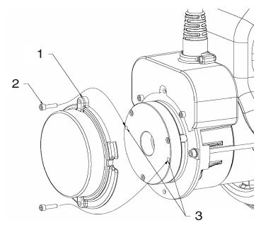
Figure 3-11. Manual Disengage
